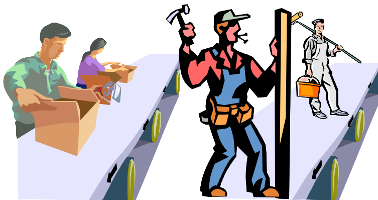
Figur 1: Till vänster rör sig produkter genom olika stationära stationer på ett löpande band. Till höger rör sig arbetskraften genom olika arbetsplatser på en byggplats.
